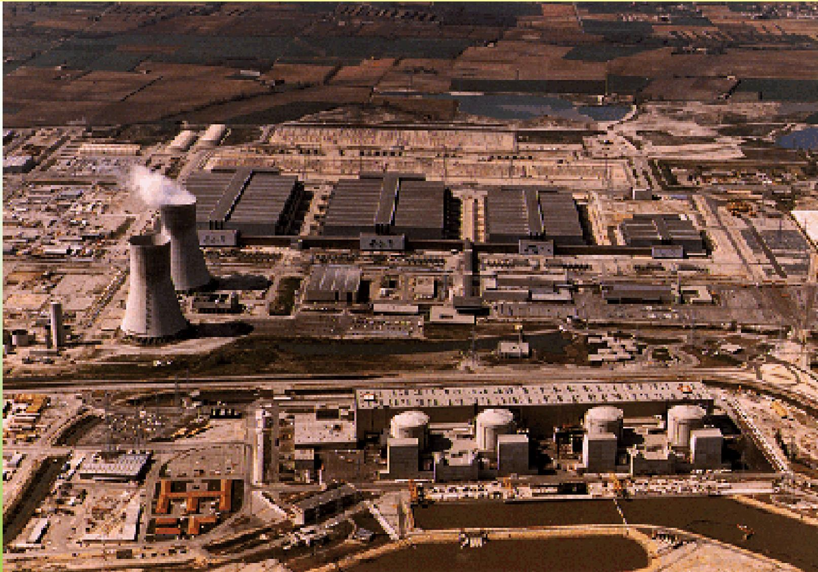
**L'impianto francese di Tricastin per l'arricchimento dell'uranio che occupa 16 km<sup>2</sup>. In primo piano, 4 centrali nucleari per un totale di 3.000 MW sono consacrate a produrre energia elettrica per alimentare l'impianto di arricchimento, in secondo piano.**
